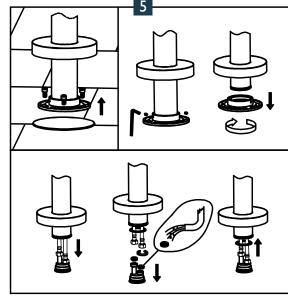
5. Verwijder de onderkant van het hoofdgedeelte volgens de tekening, spoel het filter schoon, installeer het terug in het hoofdgedeelte en voltooi de installatie.
