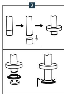
Verwijder het omhulsel van de badkraan. Schuif de rozet over de buis, hierna de flens en zet het geheel vast met schroeven.
