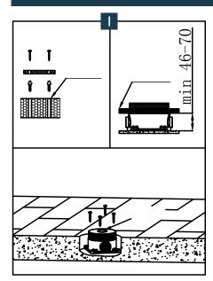
I. Bepaal de positie voor de bodemplaat en maak hiervoor ruimte in de vloer. Monteer de waterleiding op de warm wateraansluiting (links) en koud wateraansluiting (rechts). Zet de bodemplaat vast op de vloer.
